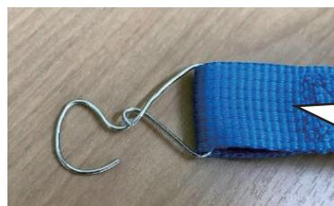
ベルトの先に針金で写真のような自助具を取り付け、ベルトをスムーズに引き出せるよう工夫
